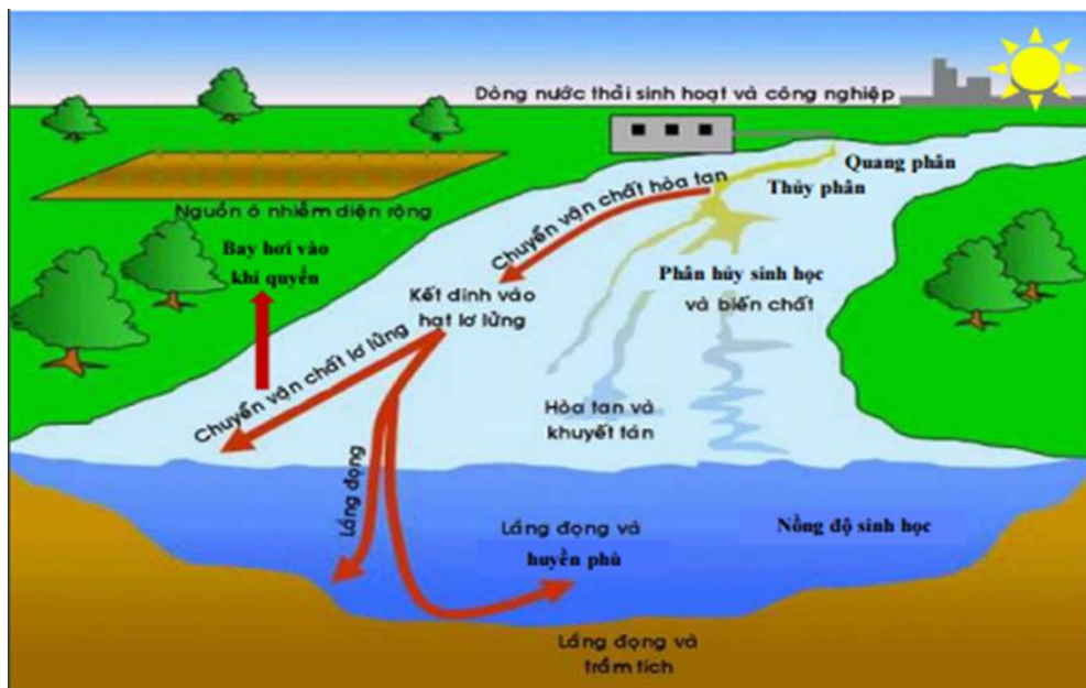
Hình 3.3. Các quá trình trong dòng chảy được mô phỏng bởi SWAT
